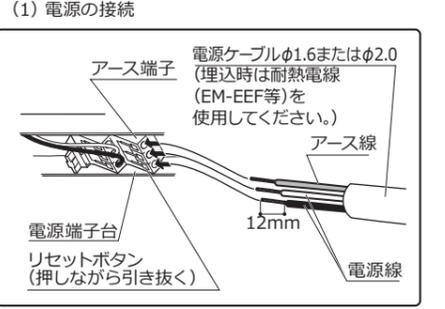
電源ケーブルを外す場合は、マイナスドライバーでリセットボタンを押しながら引き抜いてください。
